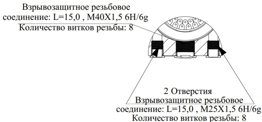
Рис. Средства обеспечения взрывозащиты для кабельных вводов.
